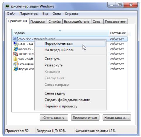
С помощью команды **Перейти к процессу** (Go To Process) легко перейти на вкладку **Процессы** (Processes), где автоматически будет выделен процесс, соответствующий выбранной изначально прикладной программе. Это особенно удобно в тех случаях, когда неизвестно имя исполняемого файла для конкретной программы.
