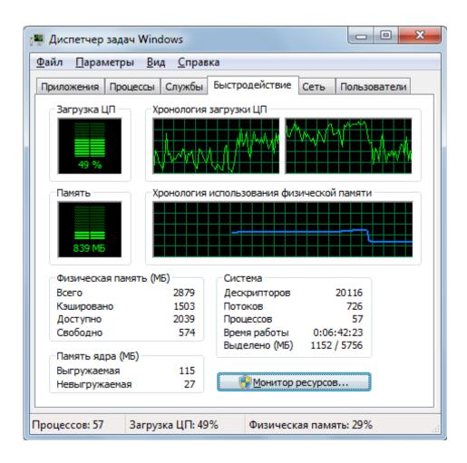
Для отображения на диаграмме **Загрузка ЦП** (CPU Usage) доли процессорного времени, в течение которого процессор работал в режиме ядра (это время будет представлено линией красного цвета), установите в меню **Вид** (View) флажок **Вывод времени ядра** (Show Kernel Times).
