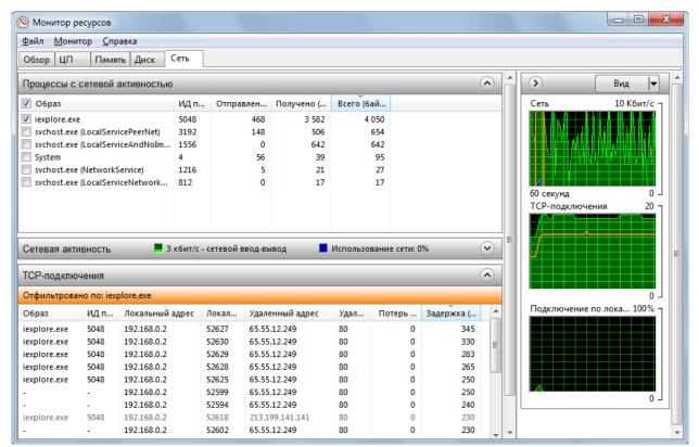
Включив фильтрацию, очень легко получить сведения о том, куда именно обращается программа, какие порты использует и как быстро она получает ответы. Таким образом, упрощается контроль за сетевой деятельностью компьютера.
